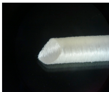
組みひも機で作製した絹製小口径人工血管 (内径1.5mm)
